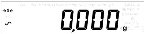
La pantalla indicará la lectura cero junto con el símbolo cero "→0←" y la ultima unidad de peso utilizada. Si la calibración automática se activa el equilibrio calibrará 15 minutos después del encendido o de nuevo después del intervalo de tiempo preestablecido.
