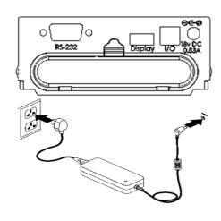
将电源线连接至天平背面的接口。将电源线接上市电。显示器将显示天平序列号、软件版本号以及天平最大量程。然后天平将自检,显示所有字段,接着会显示正在工作的符号和7段折线,它表示天平处于繁忙模式中。如果天平没有设置序列号,天平将显示破折号。之后则会显示零位以及→0←符号。
