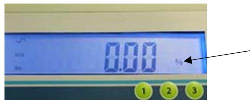
Die Waage verwendet eine Masse auf der Plattform als 100% Referenzgewicht oder ein Referenzgewicht wird über die Tastatur wie folgt eingegeben:
