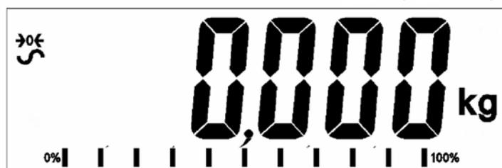
L'indicatore ha una funzione di azzeramento automatico per ovviare a lievi derive o accumuli di materiale sulla piattaforma. Tuttavia potrebbe essere necessario premere il tasto **[Esc]** per azzerare nuovamente l'indicatore se vengono visualizzate piccole quantità di peso quando la piattaforma è scarica.
