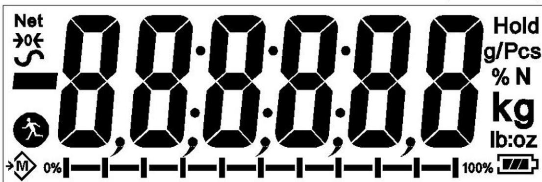
Altri simboli saranno visualizzati quando s'inserisce un valore di tara (NET) la bilancia è a zero e stabile. Se un valore è stato memorizzato o quando è stata abilitata la funzione di pesatura animali (dinamica). I simboli della batteria indicheranno lo stato di carica della batteria interna.
