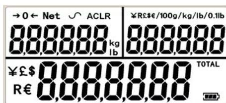
Alla fine della prova automatica visualizzerà il peso zero, se la condizione di zero è stato raggiunto e l'unità di pesatura che era in uso ultimamente. Indicatori di simboli di stabilità e di zero vengono anche visualizzati.
