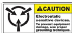
Vermeiden Sie wenn möglich das Arbeiten in Umgebungen mit statischer Aufladung, oder das Verwiegen von hochstatischen Materialien wie Plastik oder Puder, da dies die Elektronik beschädigen, oder das Ergebnis verfälschen könnte. Verwenden Sie erdende Unterlagen oder ein Masseband, um Schäden zu vermeiden
