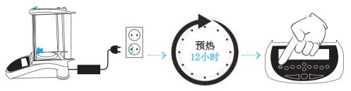
天平在进行校准和使用之前必须接通 电源并开机至少12小时,天平在使用前应该要进行校准。
