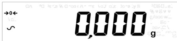
Das Display zeigt Null als Wert und die zuletzt verwendeten Gewichtseinheit, außerdem das 'Null'-Symbol [→0/T←]. Wurde die Funktion automatische Kalibrierung nach Zeitintervall aktiviert, wird die Waage 15 Minuten nach Inbetriebnahme die Kalibrierung durchführen, und dann wieder entsprechend des eingestellten Zeitintervalls.
