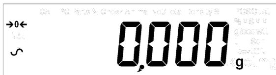
La pantalla indicará la lectura cero junto con el símbolo cero →0← y la última unidad de peso utilizada. Si la calibración automática se activa el equilibrio calibrará 15 minutos después del encendido o de nuevo después del intervalo de tiempo preestablecido.
