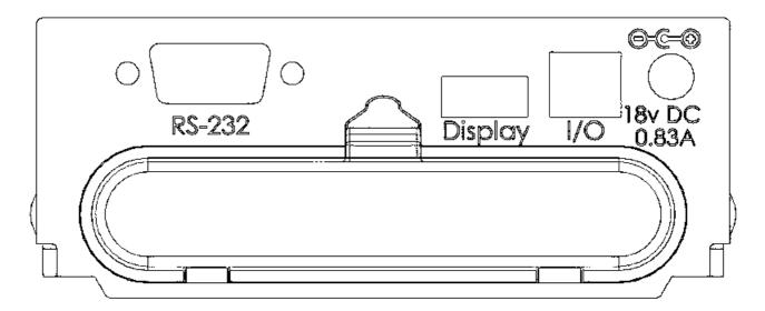
Le panneau arrière comporte une partie ou l'ensemble des connecteurs suivants selon le modèle:
