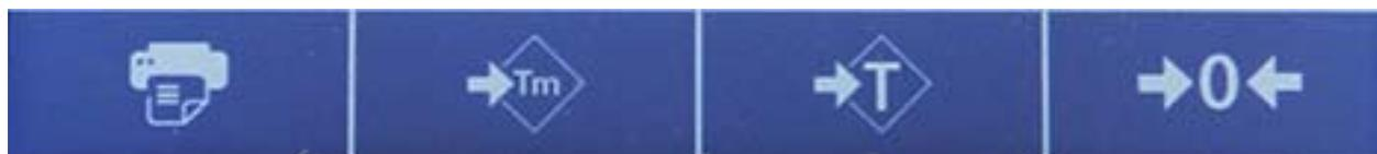
Tocando las teclas que se muestran en esta área, opera la función correspondiente. A continuación se muestran todas las claves disponibles en la pantalla de pesaje simple. La barra de visualización de la tecla de función varía según las aplicaciones seleccionadas.
