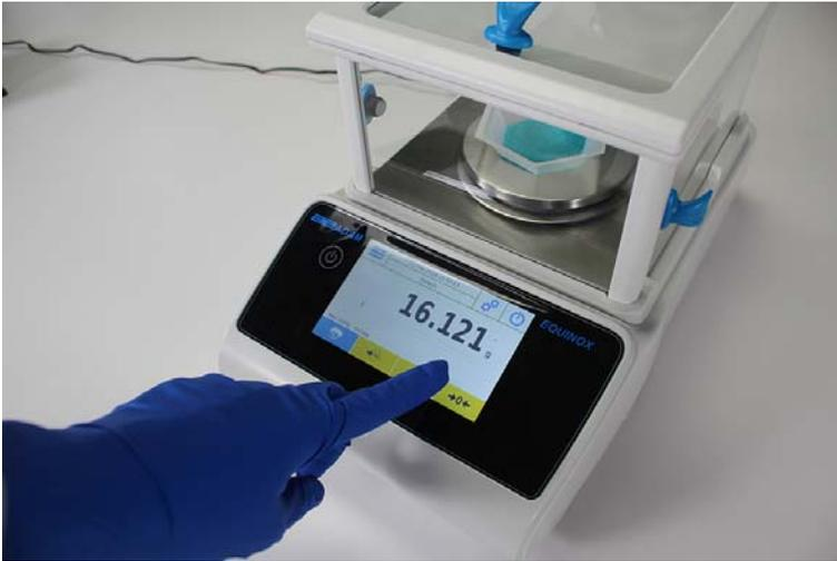
En la pantalla de pesaje de entrada, el área que muestra el peso muestra el valor de peso en la parte superior del plato de pesaje / Bandeja superior de la balanza.
