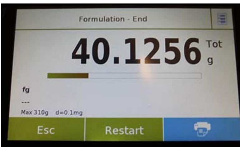
Toque la tecla "**Esc**" para salir de la función, la tecla "**Reiniciar**" para realizar una nueva medición y la tecla "**Imprimir**" para imprimir el resultado de la medición
