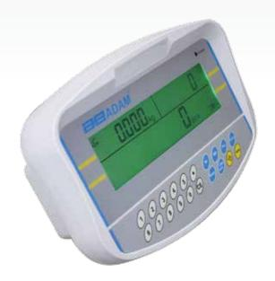
Un indicateur spécial pour le comptage ultra complet, le GC dispose d'un clavier numérique permettant de saisir le poids unitaire et la taille d'échantillon. Un grand écran rétroéclairé affiche le poids unitaire, le poids total et le nombre de pièces. Avec des fonctionnalités utiles intégrées permettent notamment au GC d'avertir l'utilisateur quand un nombre de pièces prédéfini a été atteint.
