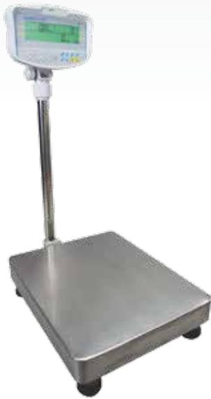
La GFC est une balance compteuse entièrement équipée avec clavier numérique pour saisir le poids unitaire et la taille de l'échantillon. Le grand écran lumineux rétro-éclairé indique le poids unitaire, le poids total et le nombre de pièces. Un plateau en inox 304 avec une base en acier doux et un indicateur en plastique ABS monté sur colonne font de la GFC une balance de comptage industrielle durable.
